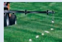
Pour optimiser chaque passage, des traceurs à mousse peuvent être montés en option sur l'outil.
